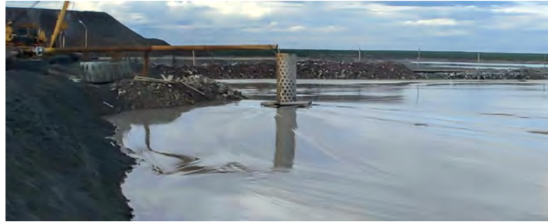
Рис. 1. Пример конусного складирования тонкодисперсных глинистых хвостов
